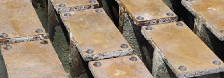
felülettisztítás és felrakó hegesztés utáni síkmarás
