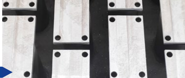
felülettisztítás és felrakó hegesztés utáni síkmarás
